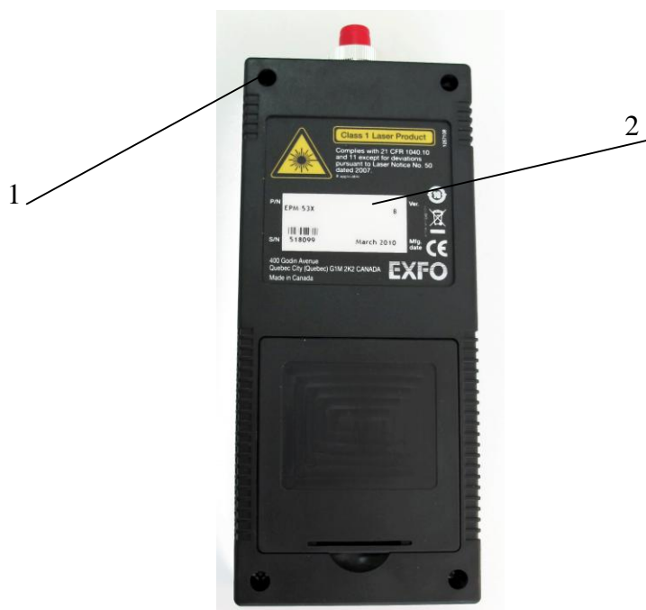
Рисунок 2 - Корпус ваттметра/источника тестера – вид сзади, защитный кожух снят 1 - место установки пломбы; 2 - место нанесения маркировки
