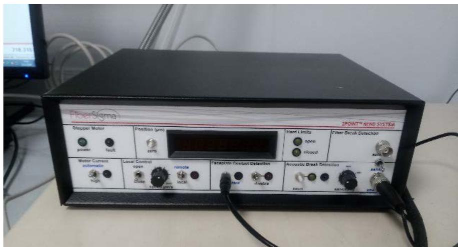
Рисунок 2. Контроллер привода шагового двигателя
